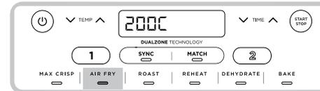
3 Utilice las flechas de TEMP (temperatura) para ajustar la temperatura que prefiera.
